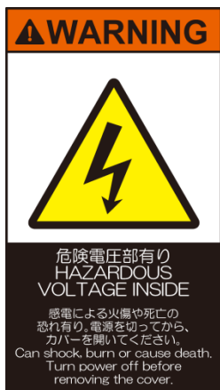
高電圧警告シール
