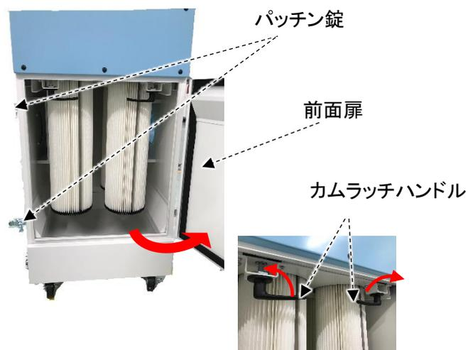
3. 取手を手前に引き、1次フィルタを取り付けプレートごと取り外します。
