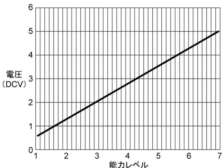
誤差が±4%あるため、電圧を設定する場合は、各レベルの中点の電圧を印加してください。
