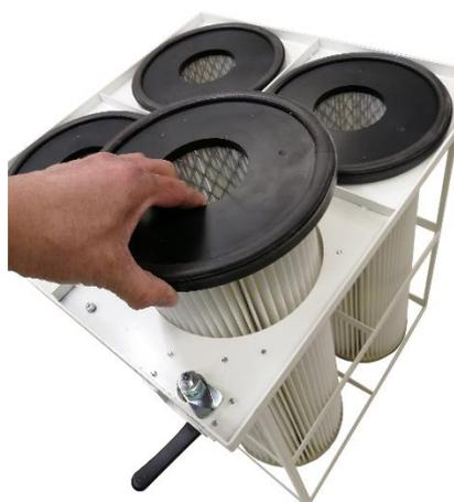
5. 1次フィルタ取り付けプレートを本体へ挿入し、カムラッチハンドルでロックします。
