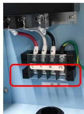
3. 電源ケーブルの電源側を電源に接続します。
