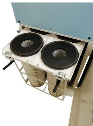
4. 1次フィルタを取り外し、新しい1次フィルタを元通りに取り付けます。
