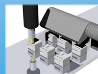
圧入部品の圧入時の擦れ 粉塵集塵
