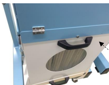
1次フィルタ室
