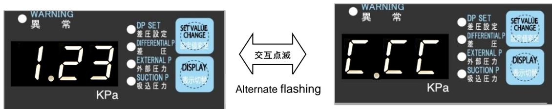
③ 「C.CC」が表示された場合、1 次フィルタの交換を行ってください。それでも、初期圧付近まで表示が戻らない場合は、2 次フィルタの交換を行ってください。→フィルタ交換の詳細は、17 ページ 6.3 項を参照ください。
