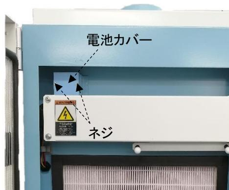
4. 爪を右に押し、ボタン電池を取り外します。
